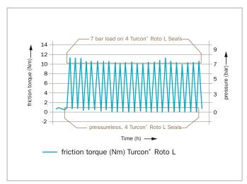
Figure 97: Dry air torque tes
