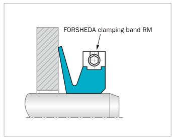
Figure 79: Clamping Band RM
